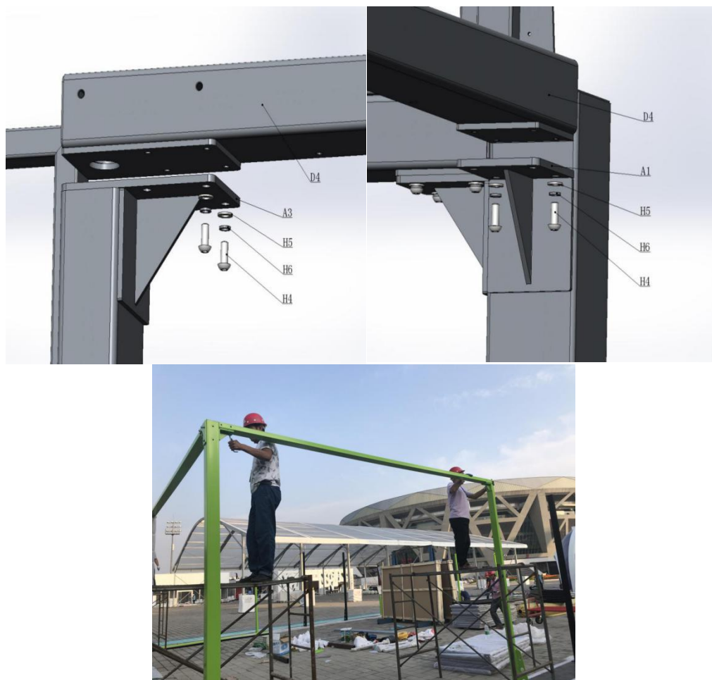
Skiss för installation av tvärstång (kortsida) Fig.8
